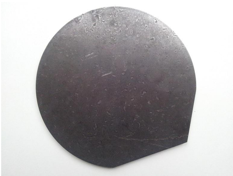
15. ábra: A kidolgozott alakzat 10 mm vastag acéllemezből készült, lézeres vágótechnikával. A nagy anyagvastagság miatt a vágási felület nem lett egyenletes, ezért a test palástját utólag le kellett köszörülni.
